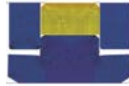
Basınç: 0 bar akma boşluğu «S»: 0.5 mm
