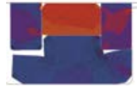
Basınç: 250 bar akma boşluğu «S»: 0.5 mm
