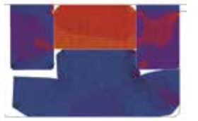
Basınç: 250 bar akma boşluğu «S»: 0.5 mm
