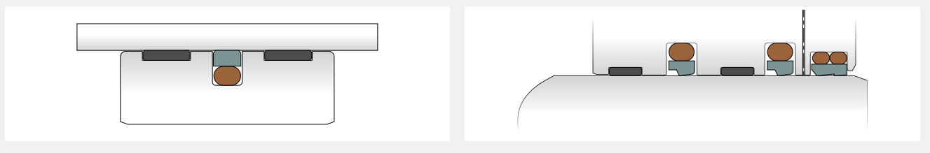
连铸机 - 钢水包滑动水口液压缸
